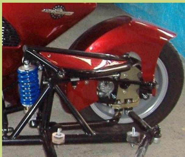
Grâce à ce système de direction, la colonne de direction ne subit plus les contraintes occasionnées par le side-car, car celles-ci sont absorbées par le châssis.
